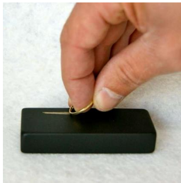
Пробен камък за изпитване на златна сплав
